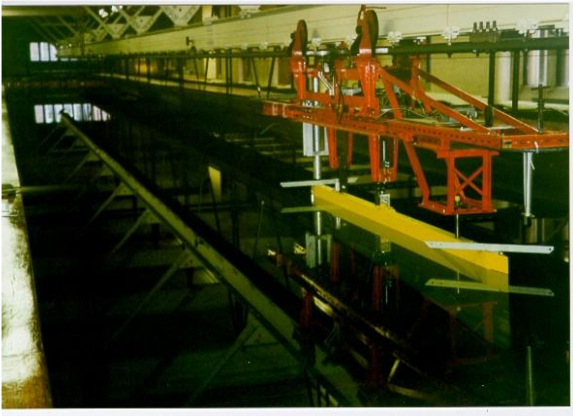
Figura 7.3.- Ensayo de la placa plana.
