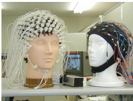
Ilustración 13. Equipos usados en EEG.
