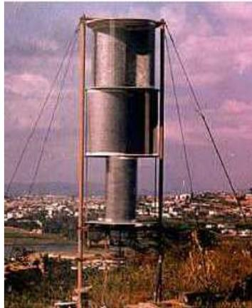
Figura 1.2. Aerogenerador Savonius
