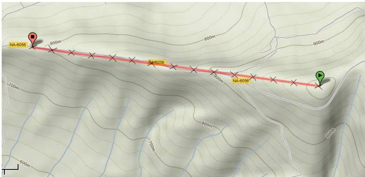
Figura5.4. Ubicación de los aerogeneradores en un plano topográfico
