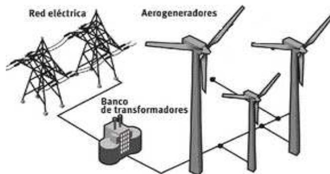
Figura7.1. Esquema del sistema eléctrico de un parque eólico
