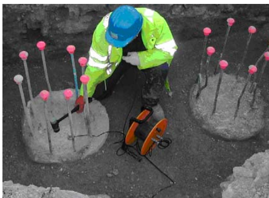
Fig. 1. Ensayo impedancia mecánica en pilotes in situ
