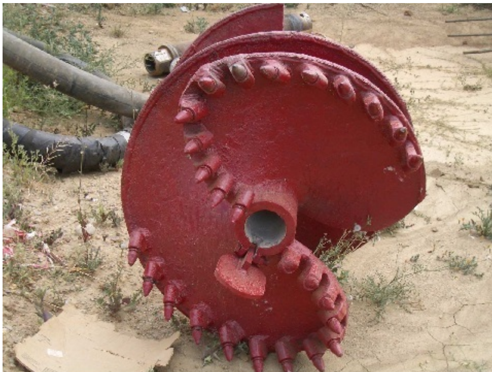
Fig. 18. Cabeza de barrena con dientes de botón y tubo central para hormigonado 24 .
