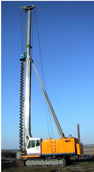
Fig. 8 y 7. Pilotadora con barrena continua y ejecución de pilotes con barrena continua.
