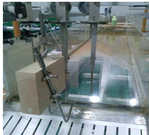
Figura nº 2. Vista de los dispositivos tipo Pitot, columnas de cristal de medición visual y transmisor de presiones diferenciales marca Rosemount modelo 2051
