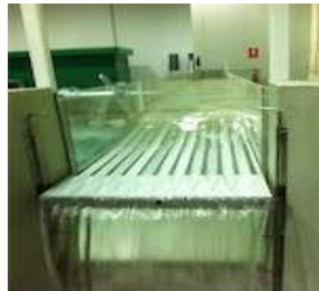
Figura nº 1. Vista de la Estructura de Captación de Fondo ubicada en el Laboratorio de Hidráulica de la Universidad Politécnica de Cartagena
