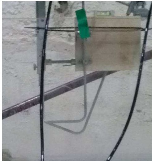
Figura nº 19. Vista lateral del canal sobre la reja con los tubos Pitot colocados en el mismo punto pero en huecos de la reja contiguos
