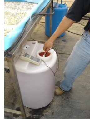
Fig.11. Medición del pH de la solución
