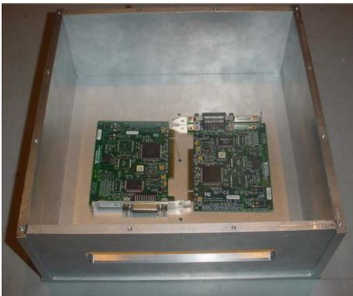
Fig. 2. Carcasa metálica para evaluar apantallamientos
