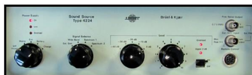
Figura 6.7. Cuadro de mando de la fuente, con la configuración utilizada en las mediciones.
