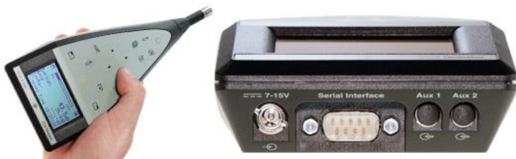
Figura 6.3. Sonómetro integrador utilizado, Brüel & Kjaer 2238 Mediator.
