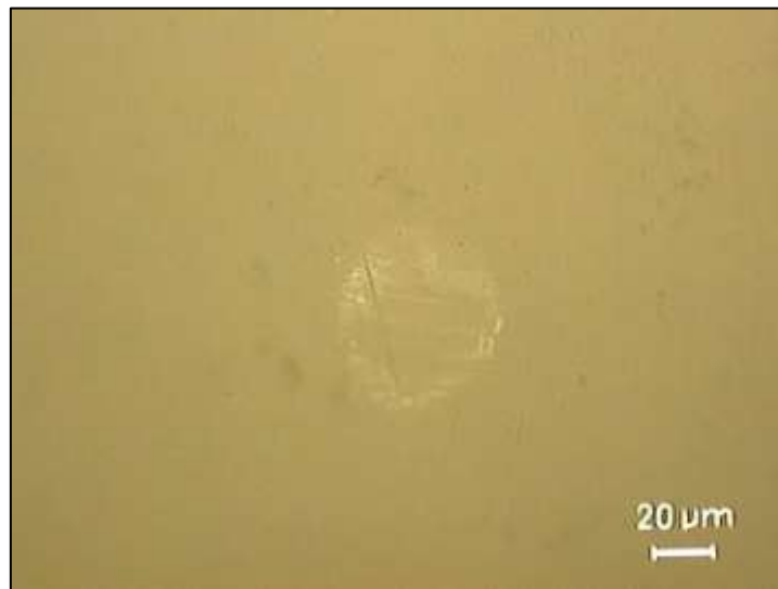
Figura 82. Imagen de la huella en el punzón en el ensayo AISI 52100 / EM-638 (50x)
