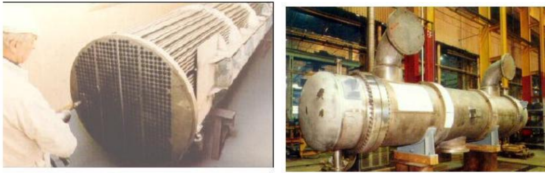
Imagen 15. Cambiadores de carcasa y tubo
