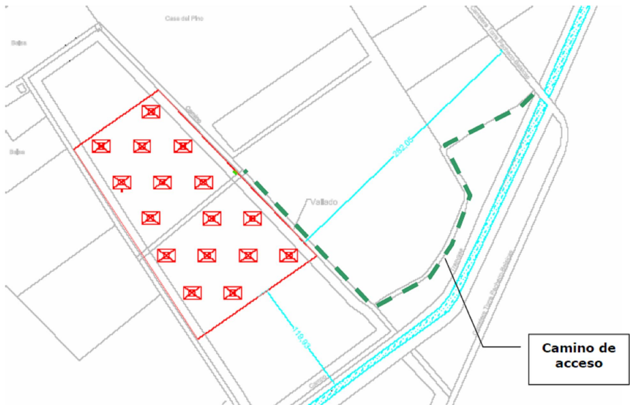
Imagen 9.-Cierre perimetral y camino de acceso
