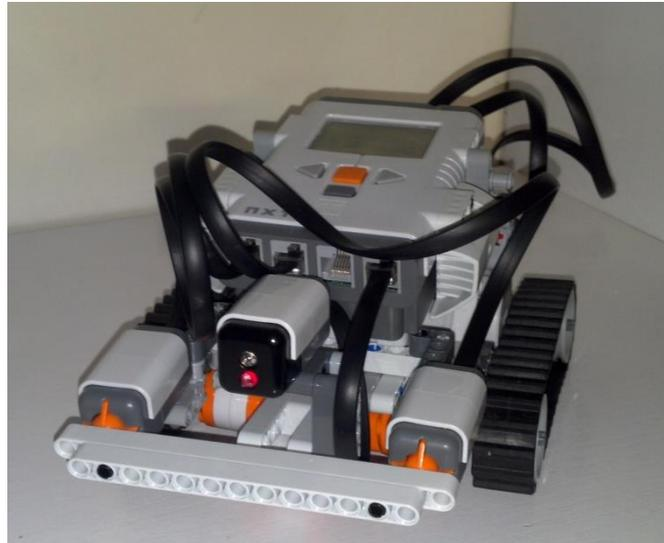
Figura 33. Robot Lego con sensores de choque y proximidad
