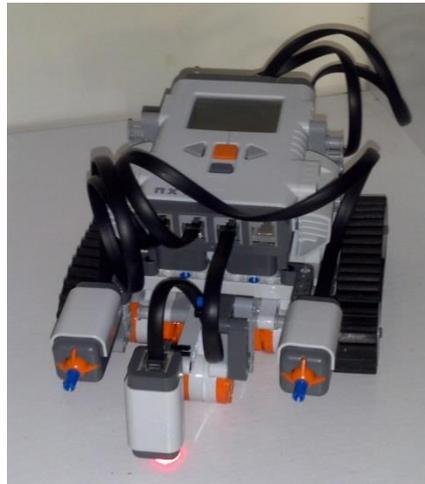
Figura 40. Robot con sensor de color
