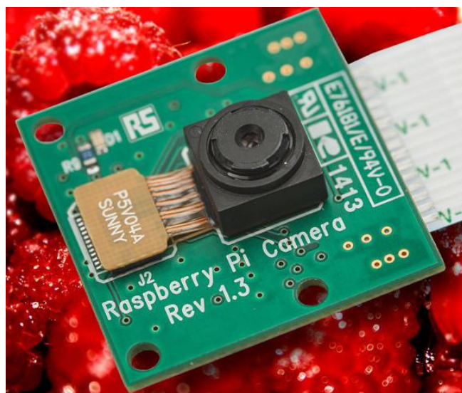
Figura 2.27 Módulo de cámara de Raspberry Pi.
