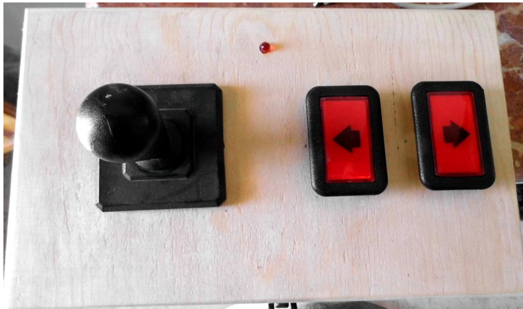
Figura 4.25 Actuadores montados en el banco de pruebas
