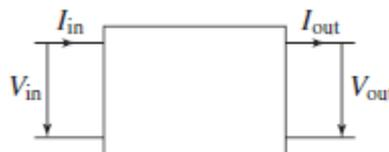
**Figura 14.** Representación de la red de dos puertos caracterizada mediante la matriz  $\begin{bmatrix} A & B \\ C & D \end{bmatrix}$
