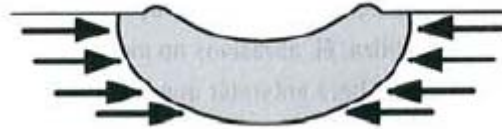
Figura 4.4 – La compresión se opone a la fisura
