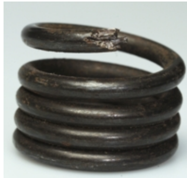
Figura 5.6 - Rotura por fatiga de un resorte helicoidal
