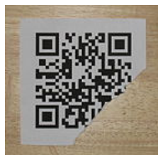
Figura 21: QR dañado pero todavía decodificable
