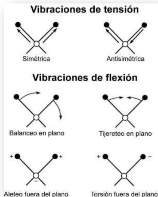
Figura 12. Disposiciones de vibración
