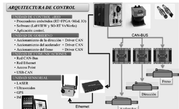
Fig. 2: Arquitectura del sistema de control del vehículo.
