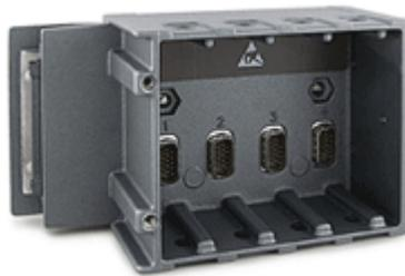
Figura 3.21. Chasis de cuatro ranuras CompactRIO.
