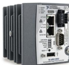
Figura 3.20. Controlador de Alto rendimiento CompactRIO.
