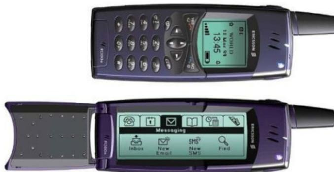
FIG. 6 – TELÉFONO MÓVIL ERICSSON MODELO R380 (2000). FUE EL PRIMERO EN COMBINAR UN TELÉFONO MÓVIL CON LAS FUNCIONALIDADES DE UNA PDA.
