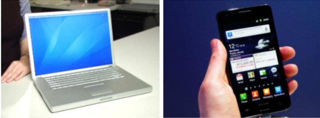
FIG. 2 – APPLE POWERBOOK G4 DE 2005 (IZQUIERDA) TIENE LA MISMA VELOCIDAD DE PROCESADOR, CANTIDAD DE MEMORIA RAM Y ESPACIO DE ALMACENAMIENTO QUE UN TELÉFONO MÓVIL SAMSUNG GALAXY S2 DE 2011 (DERECHA).
