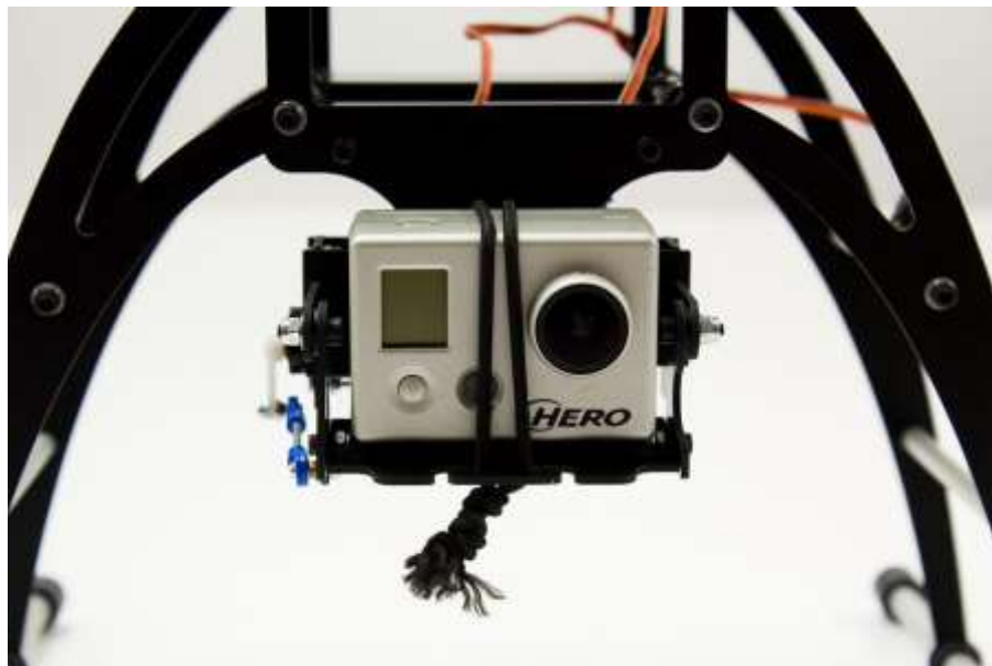
Ilustración 15: detalle estabilizador para cámara.
