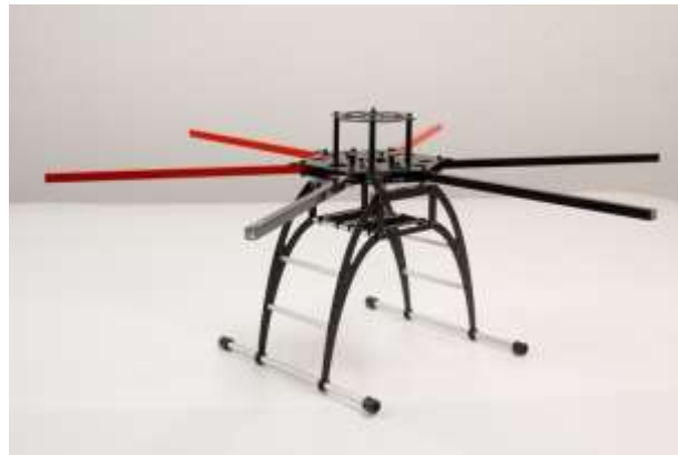
Ilustración 13: estructura utilizada en el prototipo.
