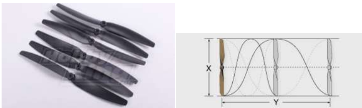
Ilustración 16: hélices y parámetros.
