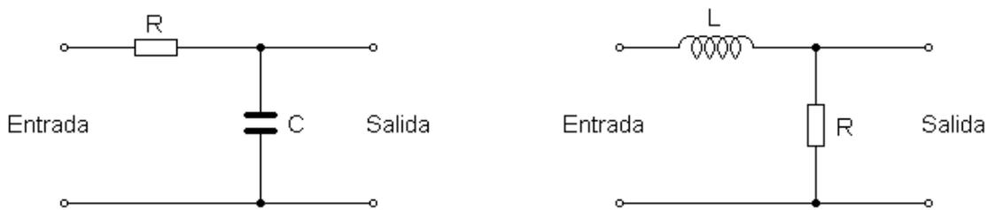
Figura 2.1: Ejemplos de filtros sencillos basados en componentes pasivos
