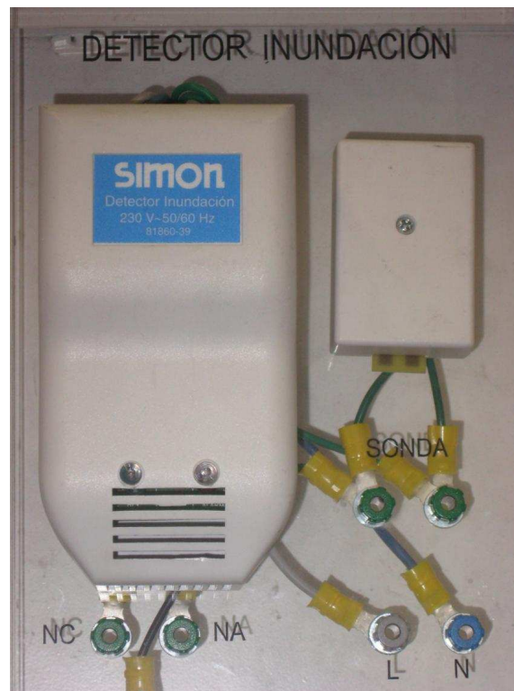
Figura 30. Detector de inundación
