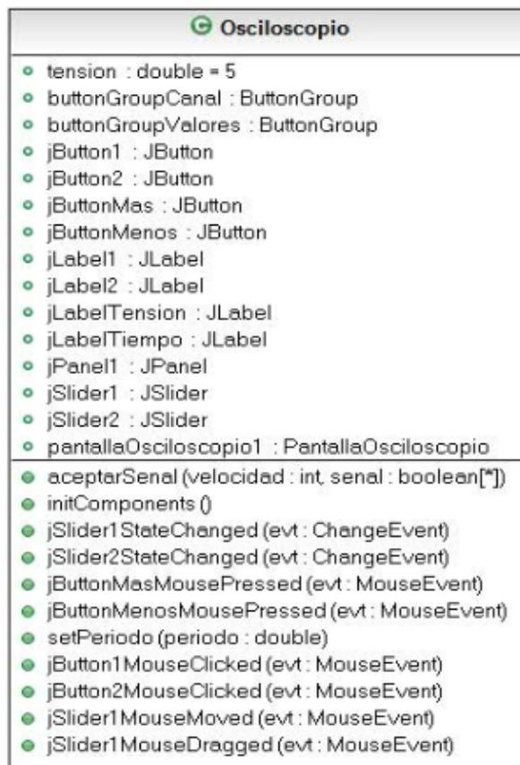
Figura 20. Diagrama UML del Osciloscopio.
