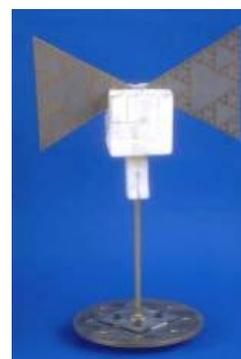
(b) Antena monopolo en plano de tierra que usa tarjetas Sierpinski
