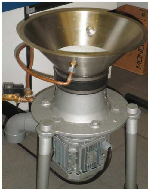
Figura 7. Equipo empleado en el pre-tratamiento de los restos de comida, trituradora STR 200.
