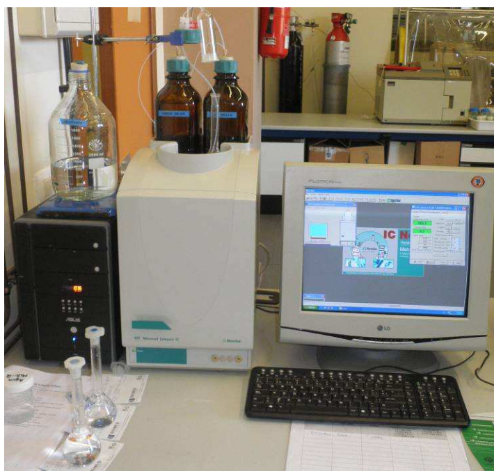
Figura 14. Determinación de aniones (Cromatógrafo Metrohm Advanced Compact IC).
