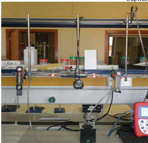
Figura 16. Sistema medición Biogás.
