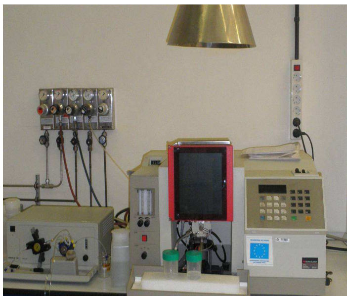
Figura 15. Equipo empleado para la determinación de metales (Perkin Elmer modelo 3110).
