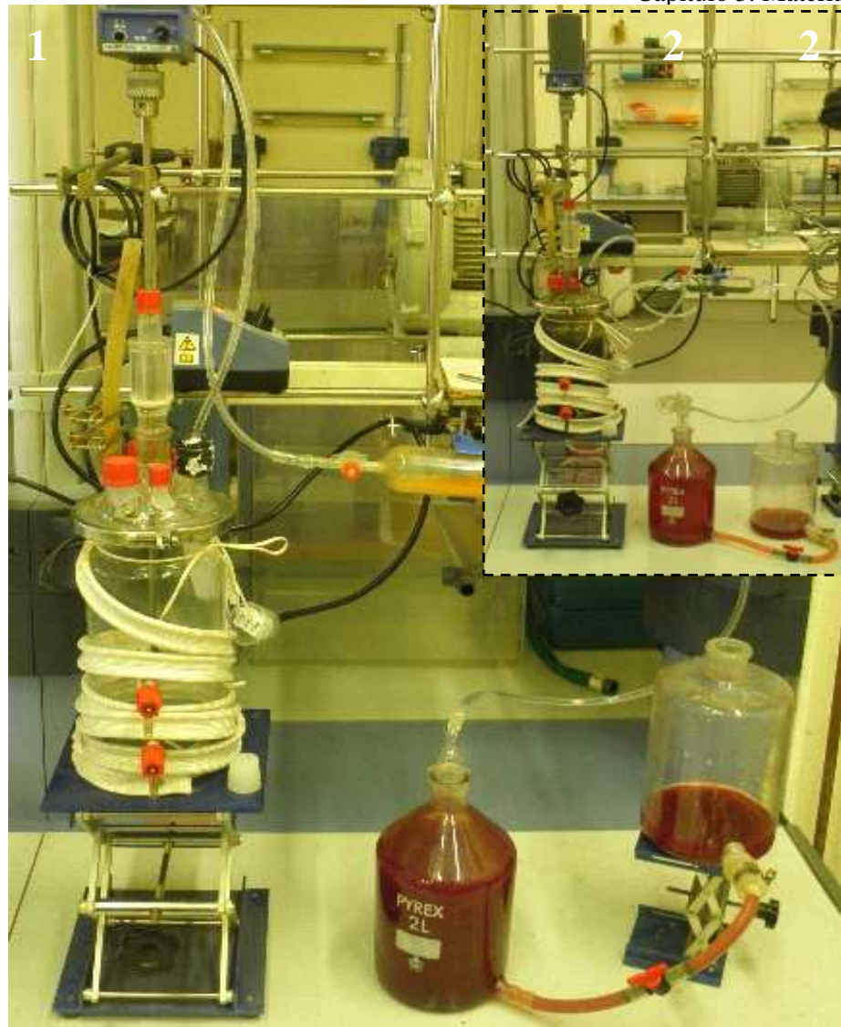
Figura 9. Puesta en marcha RC1: 1. Antes de la puesta en marcha. 2. Una vez puesto en marcha
