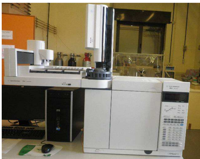
Figura 12. Cromatógrafo Agilent Tech, utilizado en la medición de los AGV y determinación de la composición del biogás
