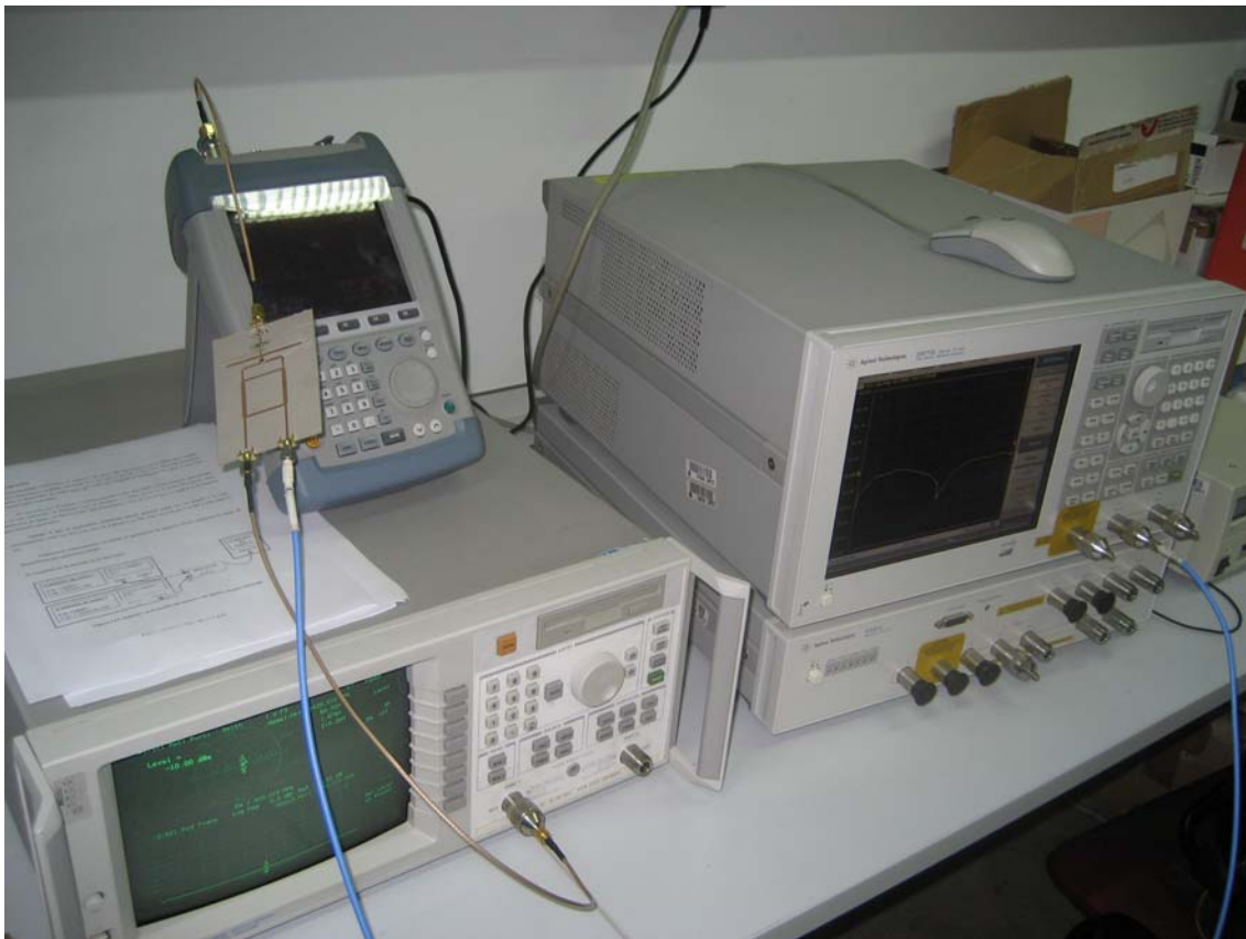
Figura 6.12: Imagen del montaje llevado a cabo para medir el espectro
