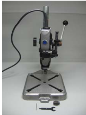
Figura 6.5: Taladro unido a soporte vertical para realizar los ViaHole
