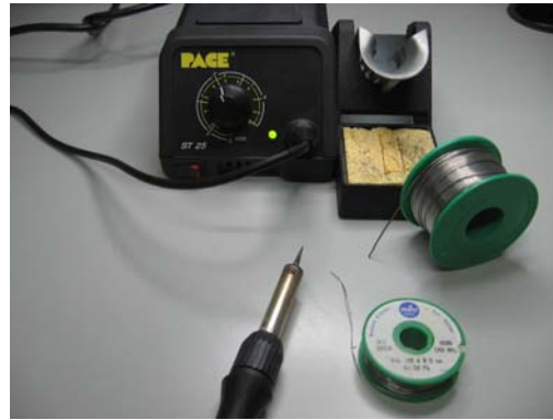
Figura 6.7: Estaño y soldador para realizar la soldadura de los componentes a la placa
