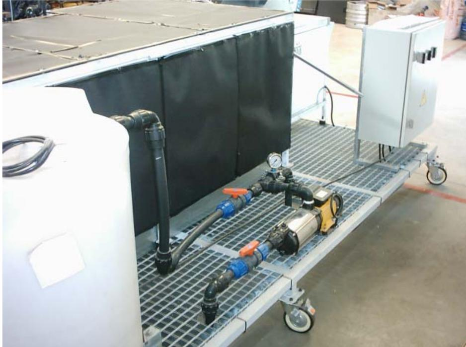
**Figura 4. 7.** Fotografía en donde se aprecian las uniones entre el motor y el depósito mediante tuberías, además de la llave que regula el paso hacia el pulverizador situada al lado del manómetro. Al fondo se aprecia el cuadro eléctrico.
