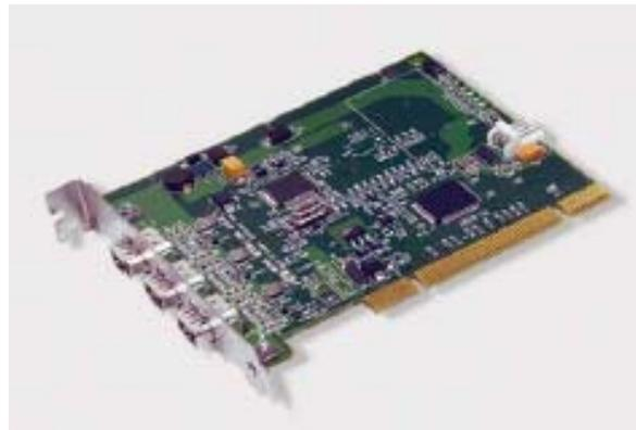
Figura 4. 21. Tarjeta de adquisición Matrox Meteor-II/1394.
