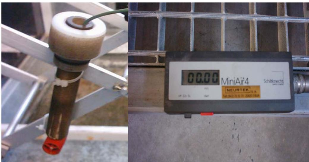
Figura 4. 9. Colocación de la sonda sobre la tijera (izquierda) y display (derecha) en donde se muestra la velocidad calculada.
