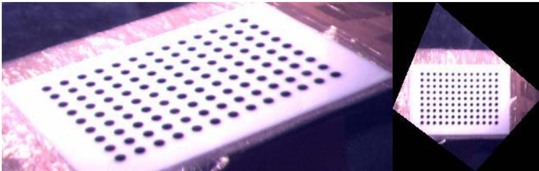
**Figura 5. 13.** Imagen de una rejilla rectangular de puntos tomada con la cámara en perspectiva, debido a esta colocación el rectángulo está deformado. En la derecha se muestra la imagen resultado de la transformación que corrige la perspectiva, mostrando la rectangularidad de la rejilla.
