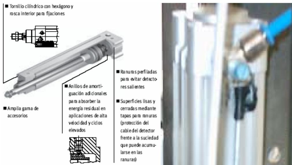
**Figura 4. 42.** Estructura interna del actuador neumático (izquierda). Entrada neumática superior con su válvula reguladora de caudal y racor conectado un tubo flexible (azul) proveniente de la caja de electroválvulas.
