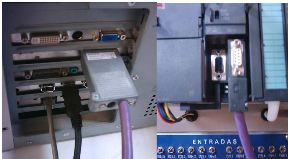
Figura 4. 34. Conectores PROFIBUS sobre la tarjeta CP 5611 del PC (izquierda) y sobre el autómeta (derecha), en violeta aparece el cable utilizado como medio físico.
