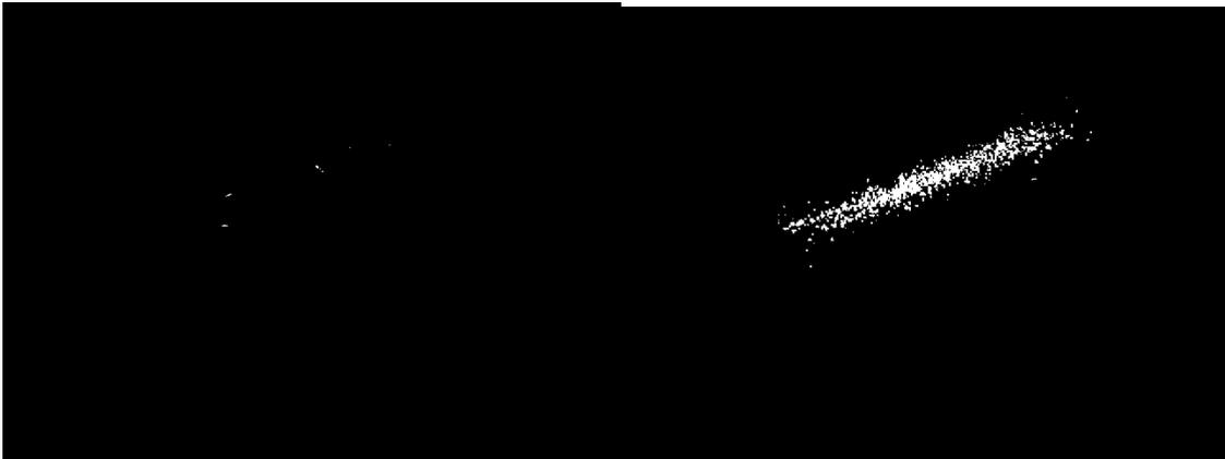
**Figura 5. 8.** Imagen resultado de una sola captura (3 puntos luminosos), imagen resultado de la integración de 100 capturas (0.33seg).
