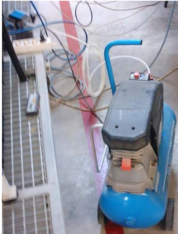
**Figura 4. 44.** Conexión entre motor y terminal de válvulas mediante un tubo blanco, para la alimentación de aire comprimido.
