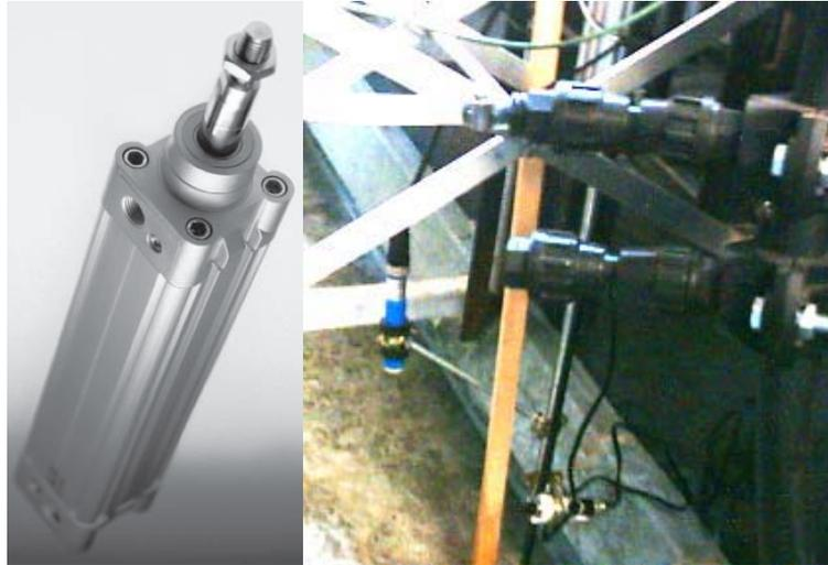
**Figura 4. 41.** Fotografía del actuador neumático y del montaje de la fuente óptica y sensor de ultrasonidos sobre el extremo de su vástago. También se aprecian las guideras de madera e hierro (en negro).
