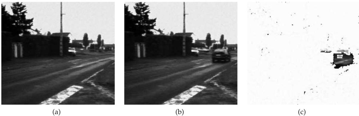
**Figura 2.44.:** (a) Imagen de referencia tomada en el instante  $t_i$ . (b) Imagen tomada en el instante  $t_j$ . (c) Imagen diferencia.
