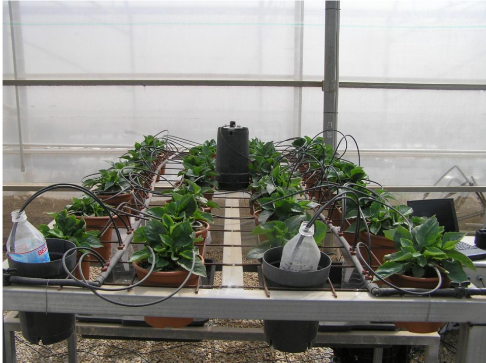
Foto 17. Detalle del sensor de radiación situado encima de la banqueta. Y debajo de la banqueta se aprecian las bandejas donde se recoge el drenaje.
