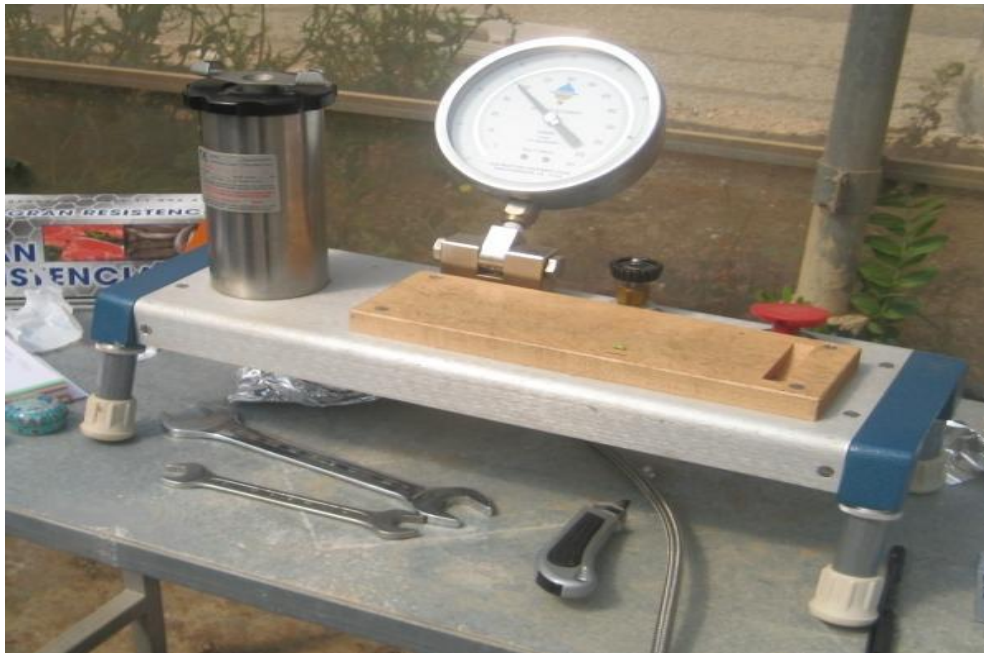
Foto 15. Cámara de Scholander para la medida del potencial hídrico.
