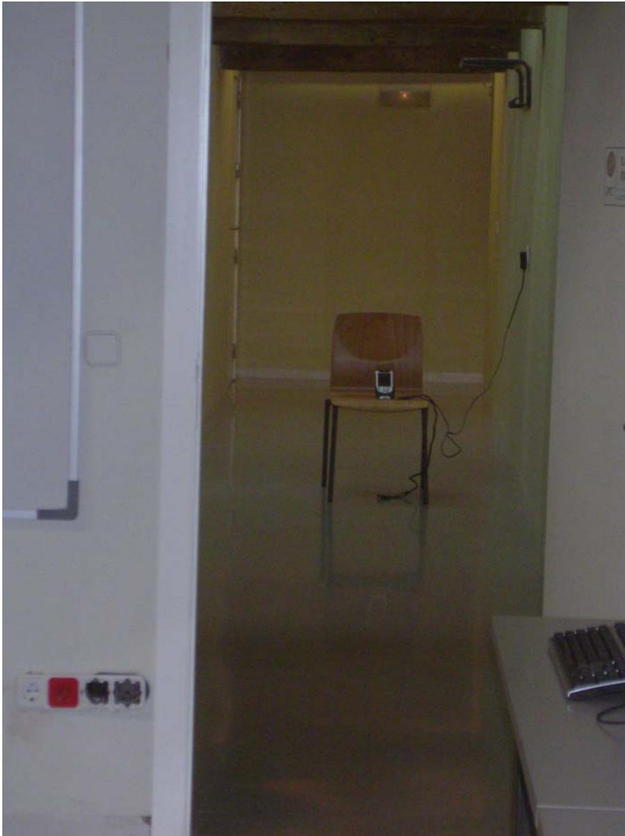
Figura 4.29: Vista del dispositivo medidor en el pasillo exterior para la prueba de 14 metros.
