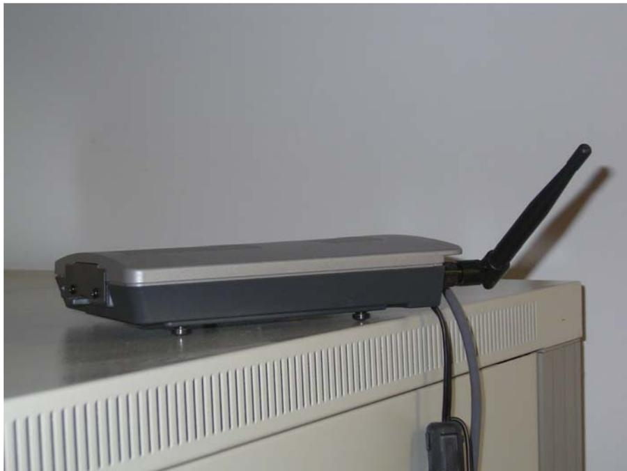
Figura E.1: Punto de acceso utilizado para la campaña de medidas en modo *managed*.
