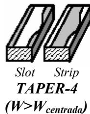
**Figura 48.** Diseño taper por modulación de la anchura de la perturbación para anchuras superiores a  $W_{centrada}$ .
