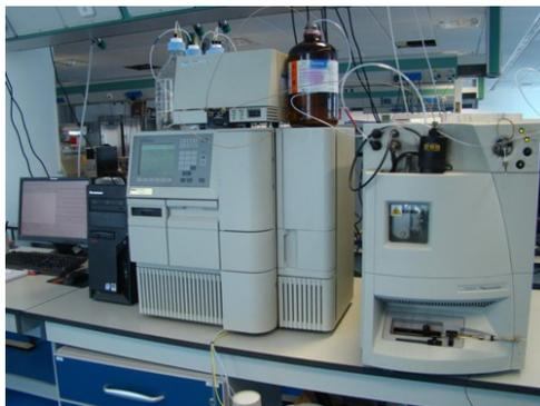
Figura 4.4: Equipo empleado (HPLC Waters Alliance 2695 con DAD modelo 2996 y detector de masas ZQ 4000)
