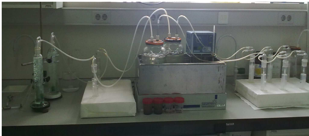
FOTOGRAFÍA 2. MONTAJE EXPERIMENTAL UTILIZADO EN EL ENSAYO DE BIODEGRADABILIDAD
