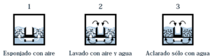
Figura 8.13.- Esquema de lavado de filtros
