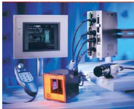
Figura 5. El sistema integrado OMRON F 160 con iluminación incorporada.
