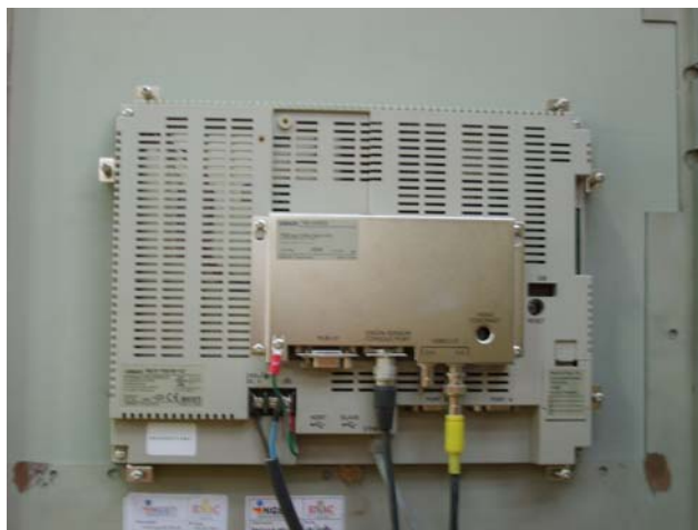
Figura 21. Tarjeta de vídeo OMRON NS-CA002 ya instalada
