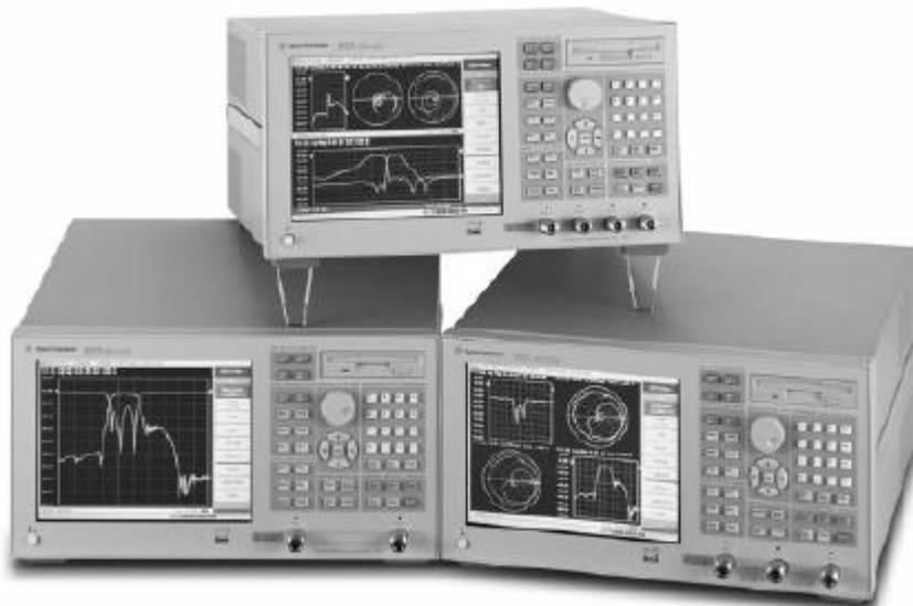
Figura 17: Analizador E5071B en sus 3 versiones de 2, 3 y 4 puertos
