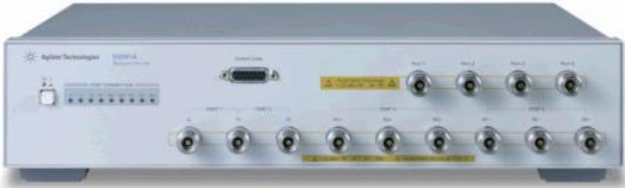
Figura 18: Ampliación Multipuerto E5091A.
