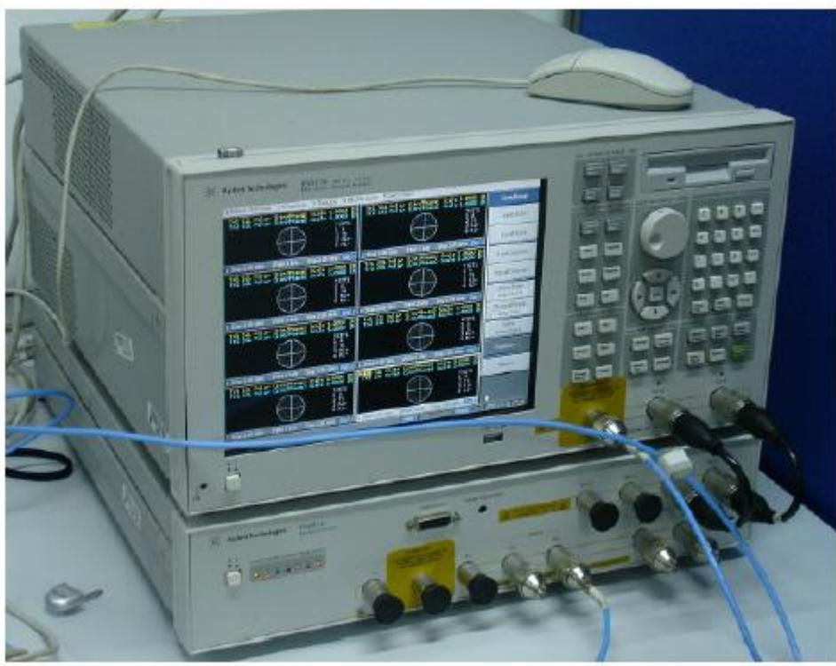
Figura 19: ENA con ampliación de puertos
