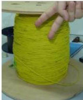
Figura 21: Bobina de 50 Metros de fibra óptica monomodo
