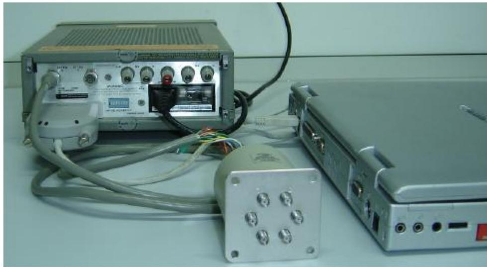
Figura 36: Interconexión Ordenador-Controlador-Conmutador.
