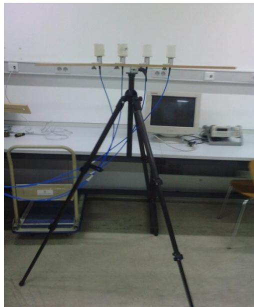
Figura 30: Array de 4 antenas en trípode
