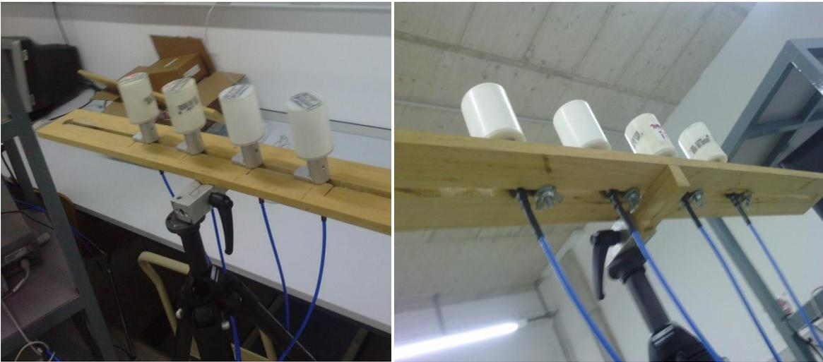
Figura 29: Array de 4 antenas sobre la guía ranurada configuradas en  $\lambda$ .
