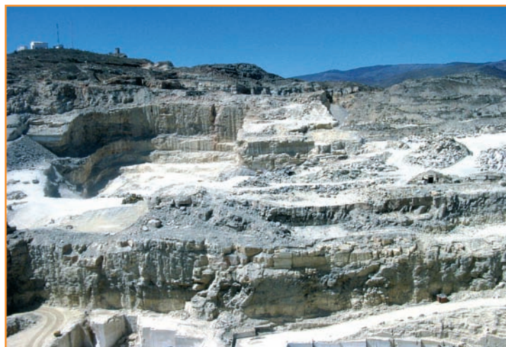
[Figura 2].- Capa de esquistos de recubrimiento del mármol en el Puntal de Macael
