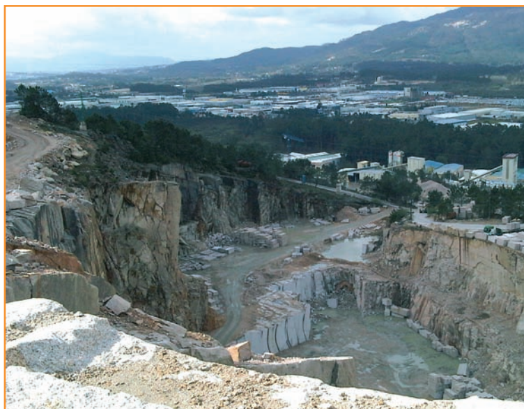
■ [Figura 1].- Acceso a la masa de granito sano en Cantera de Rosa Porriño.
