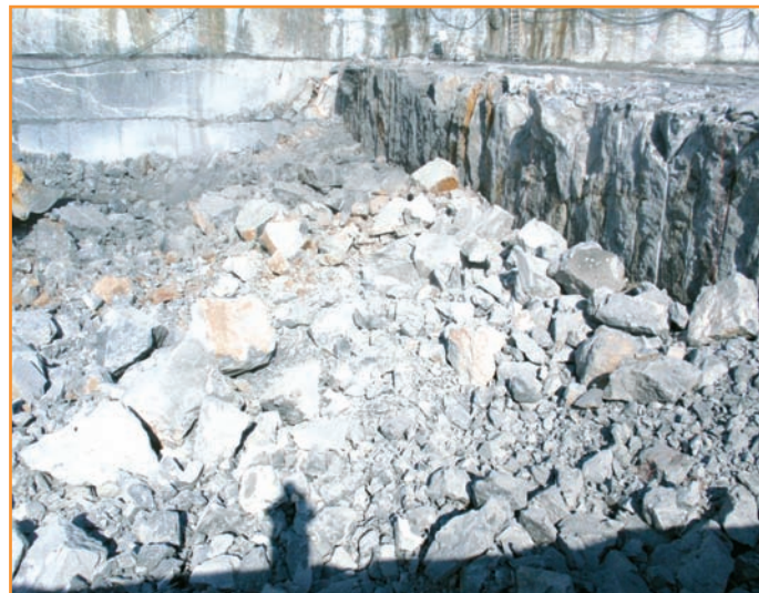
■ [Figura 7] .- Voladura con rozado horizontal inferior y precorte vertical en Markina (Guipuzkoa).
