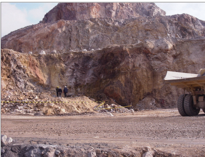
Foto 4.- Rotura circular de un banco de 10 m por alteración de la roca.
