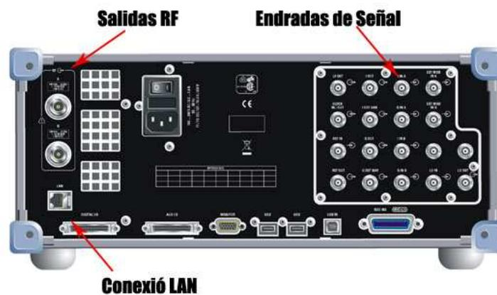
Figura 3.12 - Modulador R&S SMATE200A – Vista Trasera.
