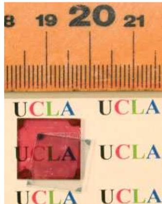
**Figura 128.** Célula solar experimental fabricada mediante procesos laminares.
