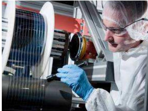
**Figura 46.** Demostración de producción de la célula solar por procesos roll-to-roll.
