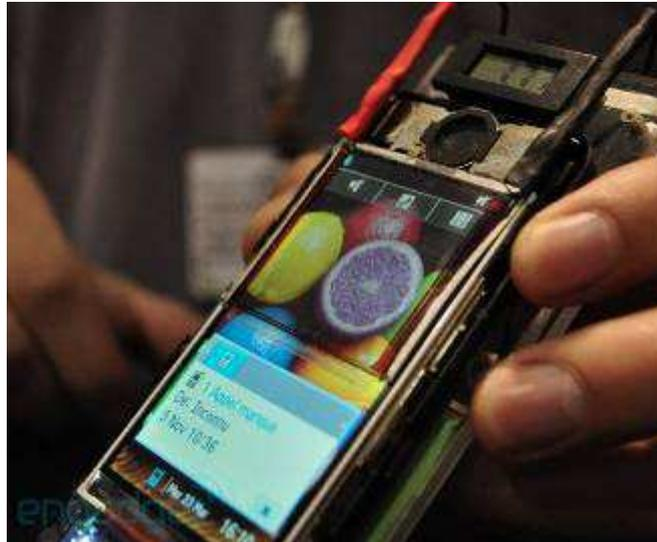
**Figura 29.** La célula fotovoltaica de WYSIPS cubre la mitad superior de la pantalla.
