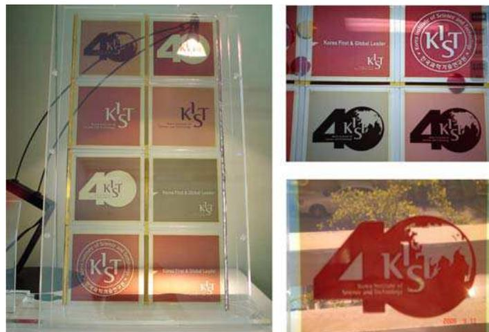
**Figura 144.** Ejemplo de las distintas tonalidades que pueden adquirir las células solares sensibilizadas por colorante.
