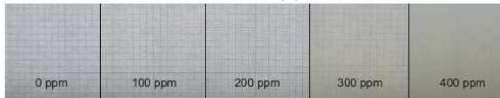
**Figura 84.** Relación de la dispersión lumínica en el material en función de la cantidad de nanocompuesto presente. Y ejemplo de la pérdida de transparencia con el aumento de la concentración del nanocompuesto.
