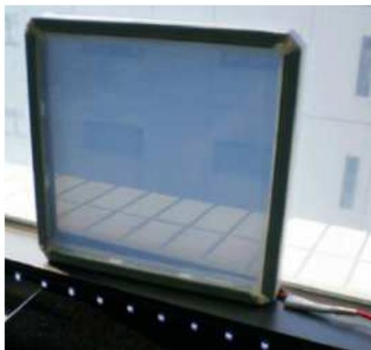
**Figura 82.** Modulo de ventana fotovoltaica de 17 cm<sup>2</sup> capaz de alimentar unos LEDs.
