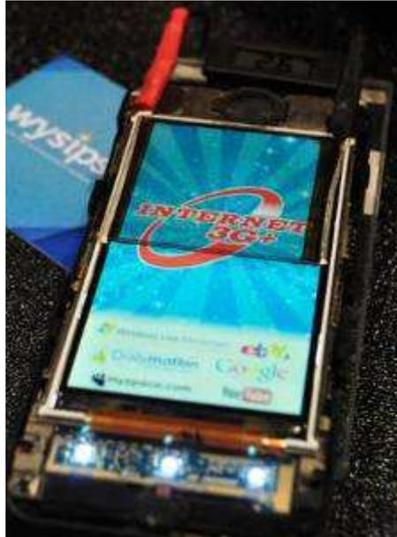
**Figura 28.** Detalle del oscurecimiento de la pantalla por la instalación de la película fotovoltaica.
