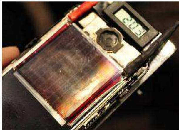
**Figura 27.** Prototipo de célula sobre la pantalla de un móvil. Detalle del voltaje generado.
