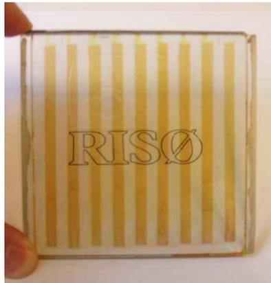
**Figura 143.** Módulo solar sensibilizado con colorante de 100 cm<sup>2</sup> con una transparencia del 50% en el rango de 400~800 nm compuesto por 9 elementos fotovoltaicos de 4,5cm<sup>2</sup> conectados en serie.
