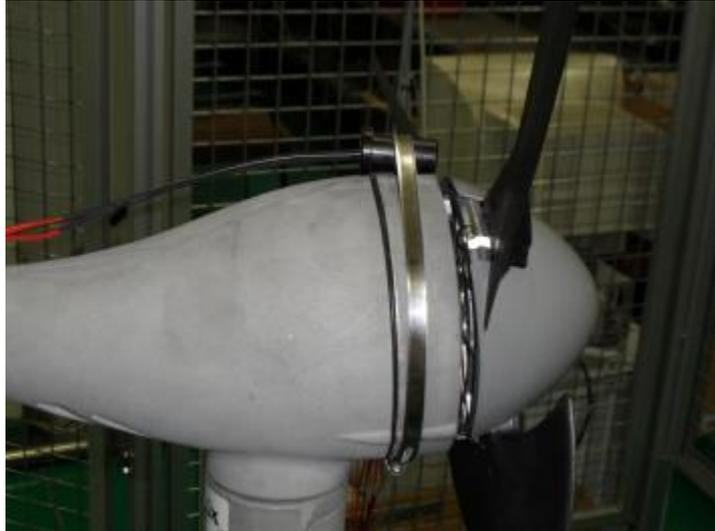
Fig. 79 Ubicación del sensor magnético de efecto Hall 1GT101DC
