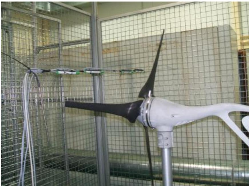
Fig. 76 Colocación de las sondas de temperatura y velocidad.
