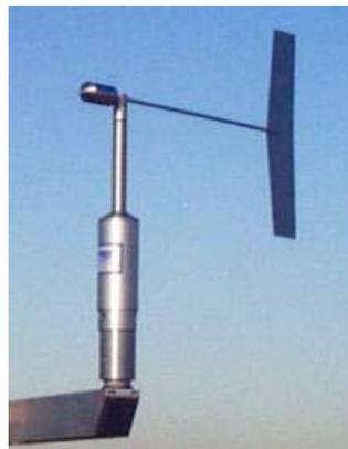
Fig. 42 Anemómetro basado en el tubo de Pitot
