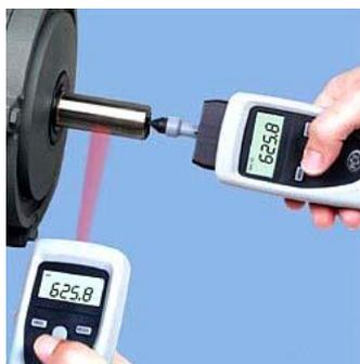
Fig. 51 Tacómetro digital de mano
