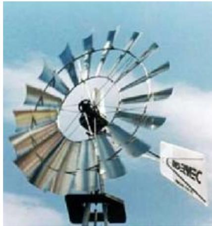
Fig. 5 Molino múltipala americano con caja reductora.
