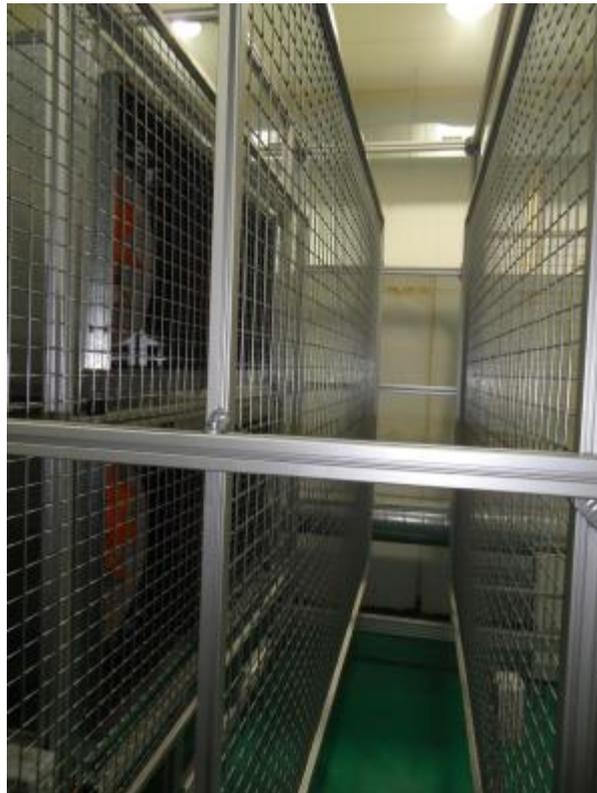
Fig. 38 Distribución de las pantallas metálicas de reducción de turbulencia
