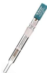
Figura 7: Electrodo de referencia Ag/AgCl utilizado para la realización de los experimentos.
