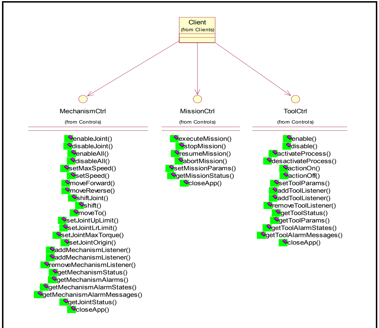
Ilustración 4: Diagrama de clase Client-Controls
