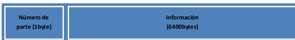
Figura 14: Estructura del mensaje de tipo PARTE
