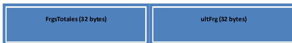
Figura 9: Estructura del mensaje de tipo OFERTA para un protocolo unicast
