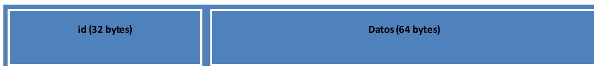
Figura 11: Estructura del mensaje de tipo DATOS para un protocolo unicast
