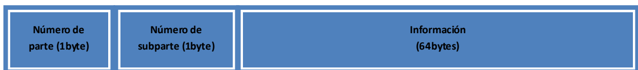
Figura 23: Estructura definitiva del tipo de mensaje PARTE
