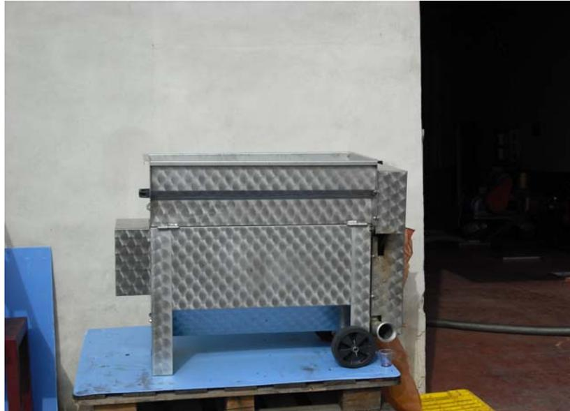
**Fotografía 18. Estrujadora-Despalilladora de laboratorio**
