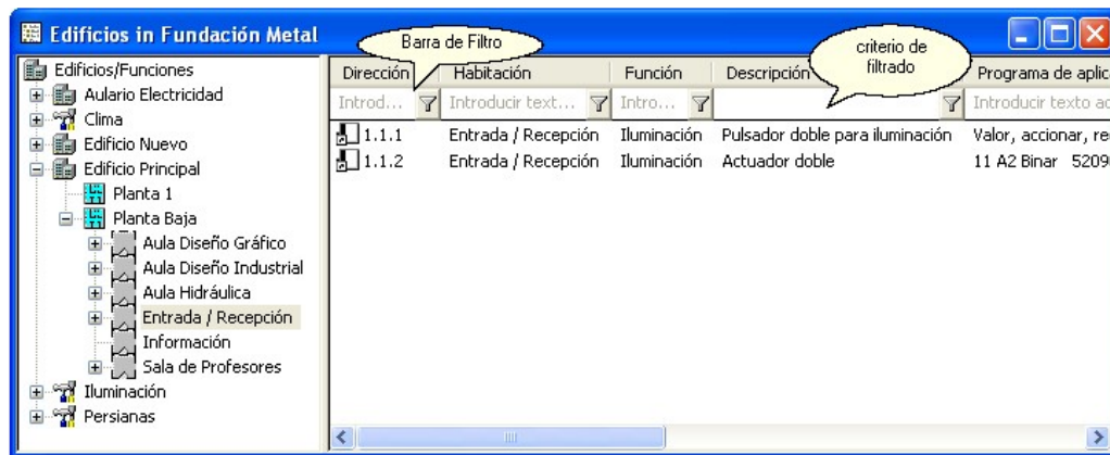
Figura 3.4. Vista de Aparatos de ETS
