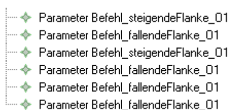
Figura 5.56. Descripción de los parámetros para el dispositivo “Entrada binaria 4 canales (1)” utilizando el DSL propuesto en EMF.
