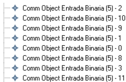
Figura 5.87. Descripción en EMF de los objetos de comunicación para el dispositivo “Entrada binaria 4 canales (5)” usando el DSL propuesto.
