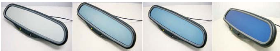
Figura 10. Retrovisor antideslumbramiento basado en dispositivos electrocrómicos.
