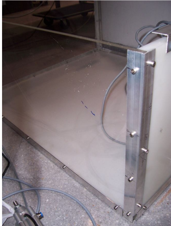
Ilustración 3. 3. Vista del anclaje mediante escuadras.
