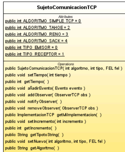
Figura 4.53 Diagrama de clase de la clase SujetoComunicacionTCP.java
